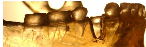
Figure 5. NO APPLIANCE INSERTED ON THE PHOTOELASTIC MODEL
